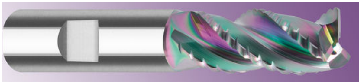
Der VHM-HPC-Alu-Schruppfräser Primus mit Innenkühlung und Multidrall. Bild: Inovatools Eckerle & Ertel GmbH
