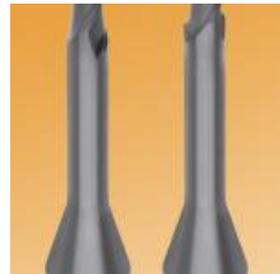
Inovatools stattet Fräser der HQ-Linie mit einer speziellen CVD-Diamantbeschichtung aus. Diamant ist hart und verschleißfest, bei niedrigen und mittleren Temperaturen chemisch fast vollständig inert und macht Zerspanwerkzeuge durch seine geringe Klebeneigung und hohe Temperaturleitfähigkeit höchst leistungsfähig.
