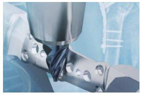
Beim Abzeilen einer Titan-Knochenplatte ist laut Inovatools der Bogensegmentfräser CURVEMAX im Gegensatz zu einem herkömmlichen Kugelfräser bis zu 85 Prozent schneller.
