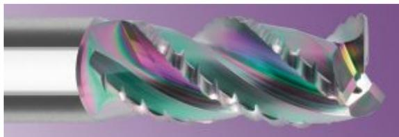
*Der VHM-HPC-Alu-Schruppfräser „Primus“ mit Innenkühlung und Multidrall ist konsequent auf extrem hohe Vorschübe bei ruhigem, vibrationsarmem Lauf und geringer Leistungsaufnahme ausgelegt. (Bildnachweis: Inovatoools Eckerle & Ertel GmbH)*
